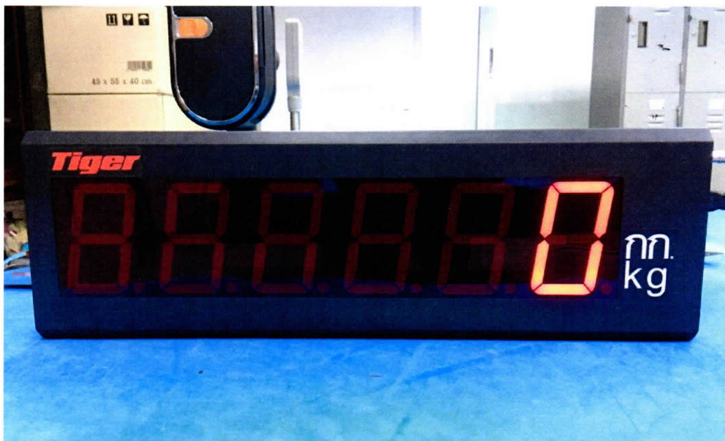
รูปที่ ๑ ส่วนแสดงค่าที่ต่อออกมาภายนอก ยี่ห้อ TIGER รุ่น TRD-๐๒
